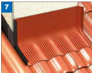
(Bild 7) Eckvariante 2: DELTA®-Anschlussband an den Deckwerkstoff anformen.
