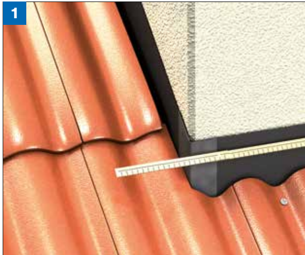
(Bild 1) Untergründe reinigen. DELTA®-Anschlussbänder abmessen. Müssen traufseitige Ecken ausgebildet werden, den auf beiden Seiten notwendigen Überstand einplanen.
