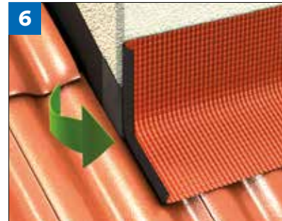
(Bild 6) Eckvariante 2: Den Überstand auf beiden Seiten umlegen, so dass die Klebefläche sichtbar ist.
